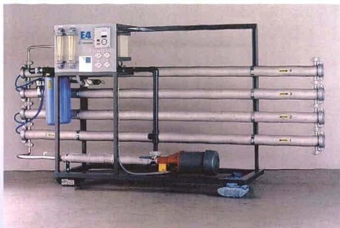
Sistema de Microfiltración (Gentileza AGUASIN)
