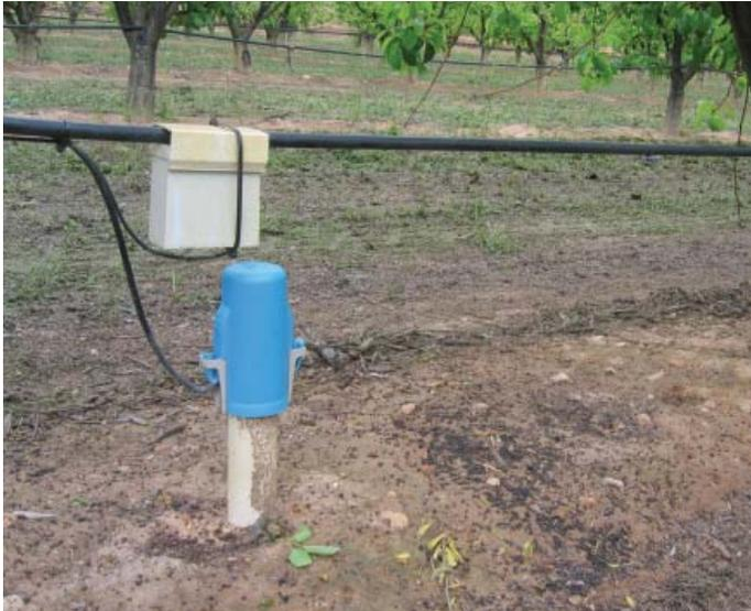
Sondas capacitivas instaladas en un campo de pera y durazno en Murcia.
