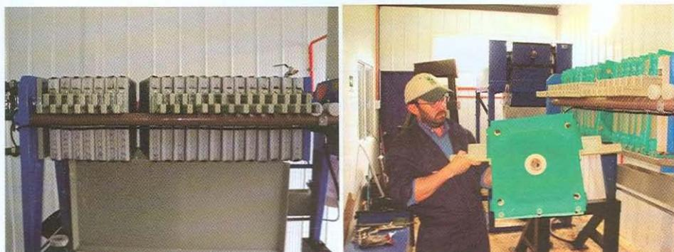
Figura 3.5 Filtro de prensa. Placas de prensado y filtrado.
