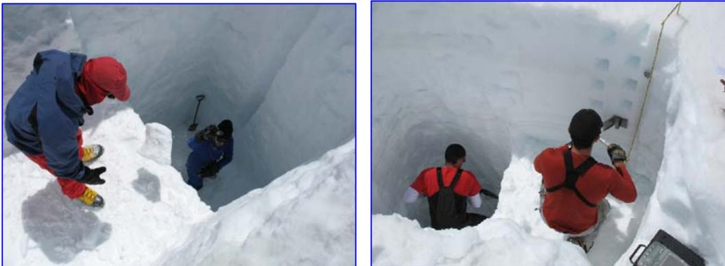
Figura 2. Pozo Estratigráfico. Foto izquierda: en glaciar Echaurren Norte. Foto derecha: en glaciar Juncal.
