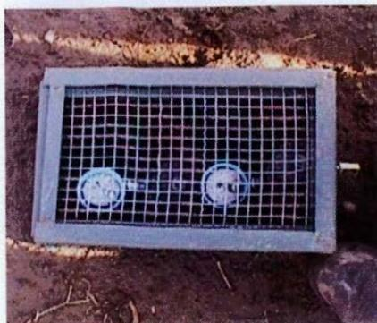
*Instalación de tensiómetros.*
