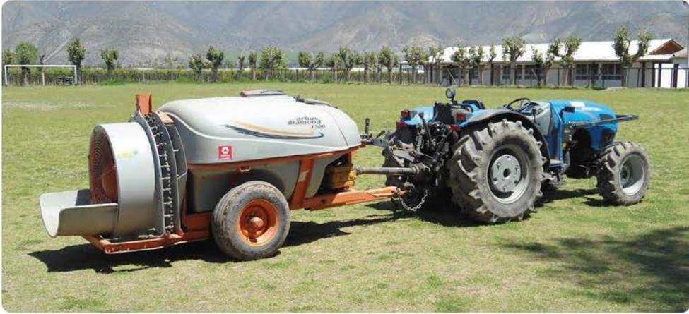
**Figura 9.2.** Pulverizador hidroneumático utilizado en la actualidad para aplicaciones de plaguicidas en frutales.
