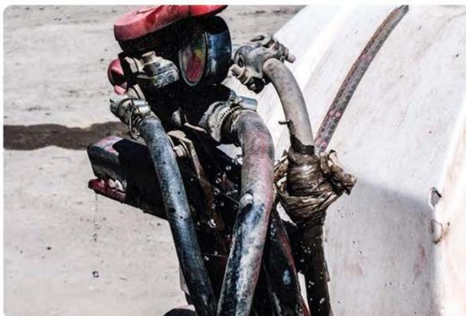
**Figura 9.6.** Fugas en circuito hidráulico, permitiendo pérdida de producto y contaminación medioambiental.
