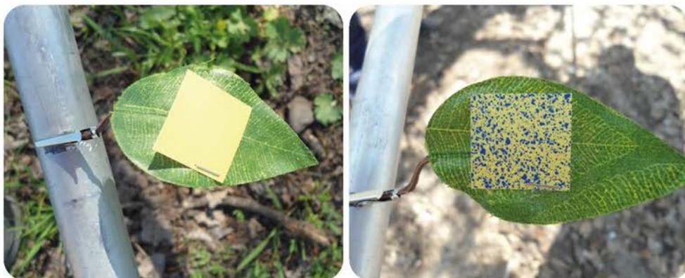
**Figura 9.10.** Uso de papeles hidrosensibles para comprobación de cubrimiento. Izquierda: papel hidrosensible antes de pulverizar; Derecha: papel hidrosensible después de una pulverización eficiente.
