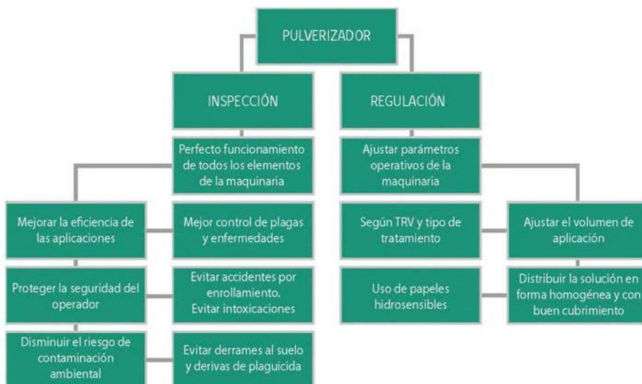
**Figura 9.4.** Esquema de inspección y regulación de un pulverizador hidroneumático.
