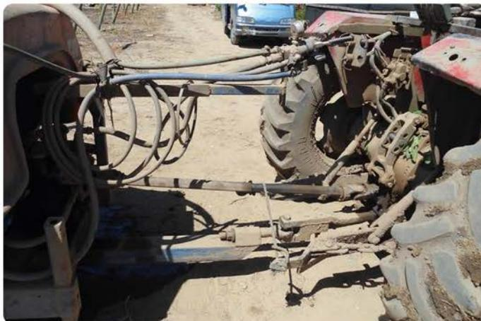
**Figura 9.7.** Junta cardánica sin funda protectora, facilitando el riesgo de accidentes por enrollamiento.
