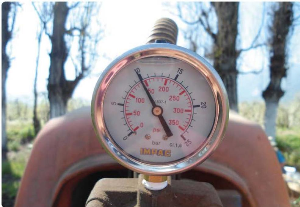
Figura 9.5 Manómetro con graduación correcta de 0 a 25 bares para un pulverizador hidroneumático.
