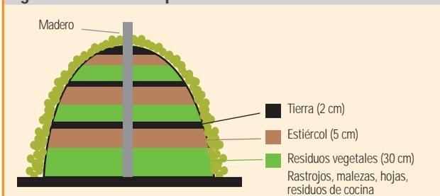
Este método asegura buenas proporciones de cada tipo de materia prima. Es especialmente útil cuando no se utiliza una máquina revoladora, ya que permite partir con los materiales distribuidos uniformemente en la pila. Las dimensiones recomendadas son aproximadamente: 1,5 m de ancho; 1,2 m de alto y el largo esta determinado por la cantidad de material disponible.
