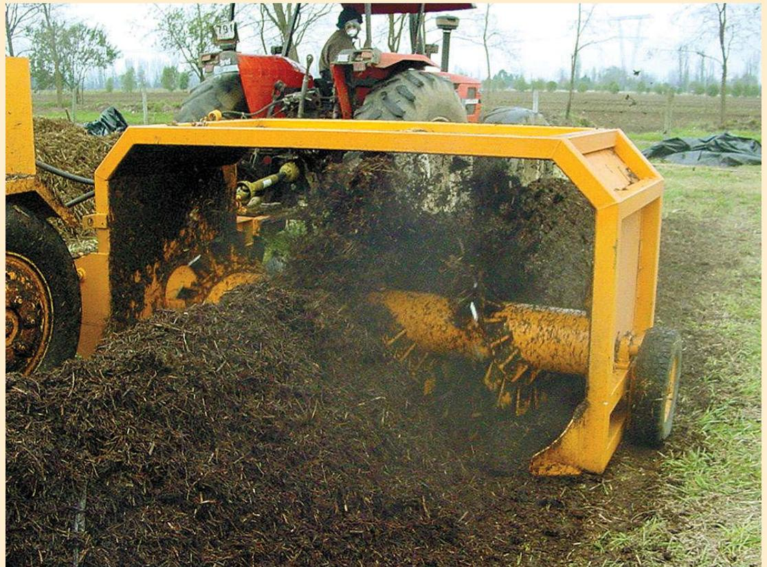
*Proceso de volteo de una pila de compost, lo que permite incorporar el oxígeno necesario para la actividad de los microorganismos.*
