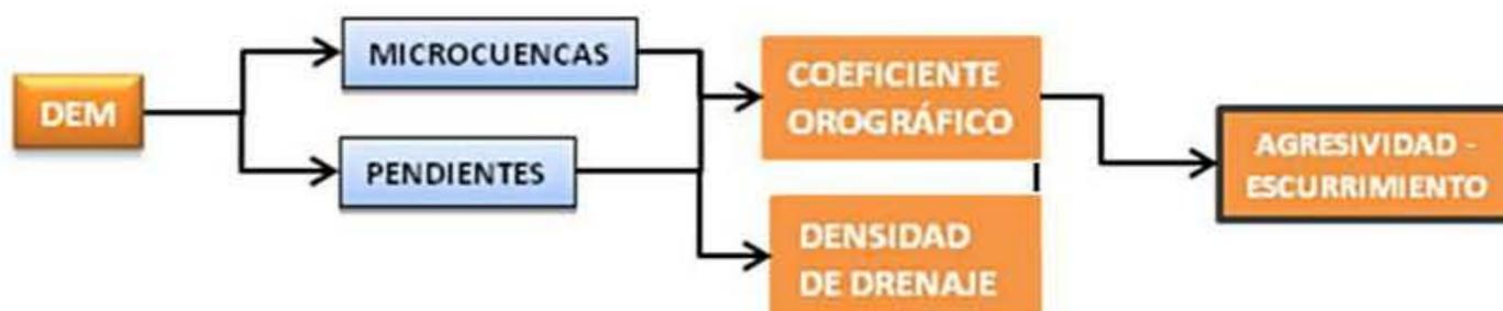
La obtención de este índice se basó en la información proporcionada por el Modelo Digital de Elevación (DEM) generado por el sensor Aster de Japón (ASTER Digital Elevation Model V001) que está disponible en formato raster, con una resolución 30 x 30m por pixel, en coordenadas geográficas Lat/Long y Datum WGS84, Huso 19 Promedio. El DEM correspondiente a la superficie ocupada por Chile fue ajustado a los límites continentales del país. La figura 12 muestra el modelo de elevación digital regional.
