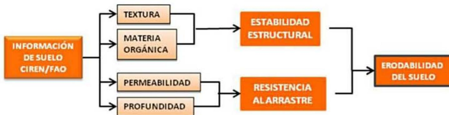
La erodabilidad del suelo (figura 18) se obtuvo considerando el desprendimiento de partículas por impacto de la gota de agua (estabilidad estructural) y el transporte (resistencia al arrastre por escorrentía).
