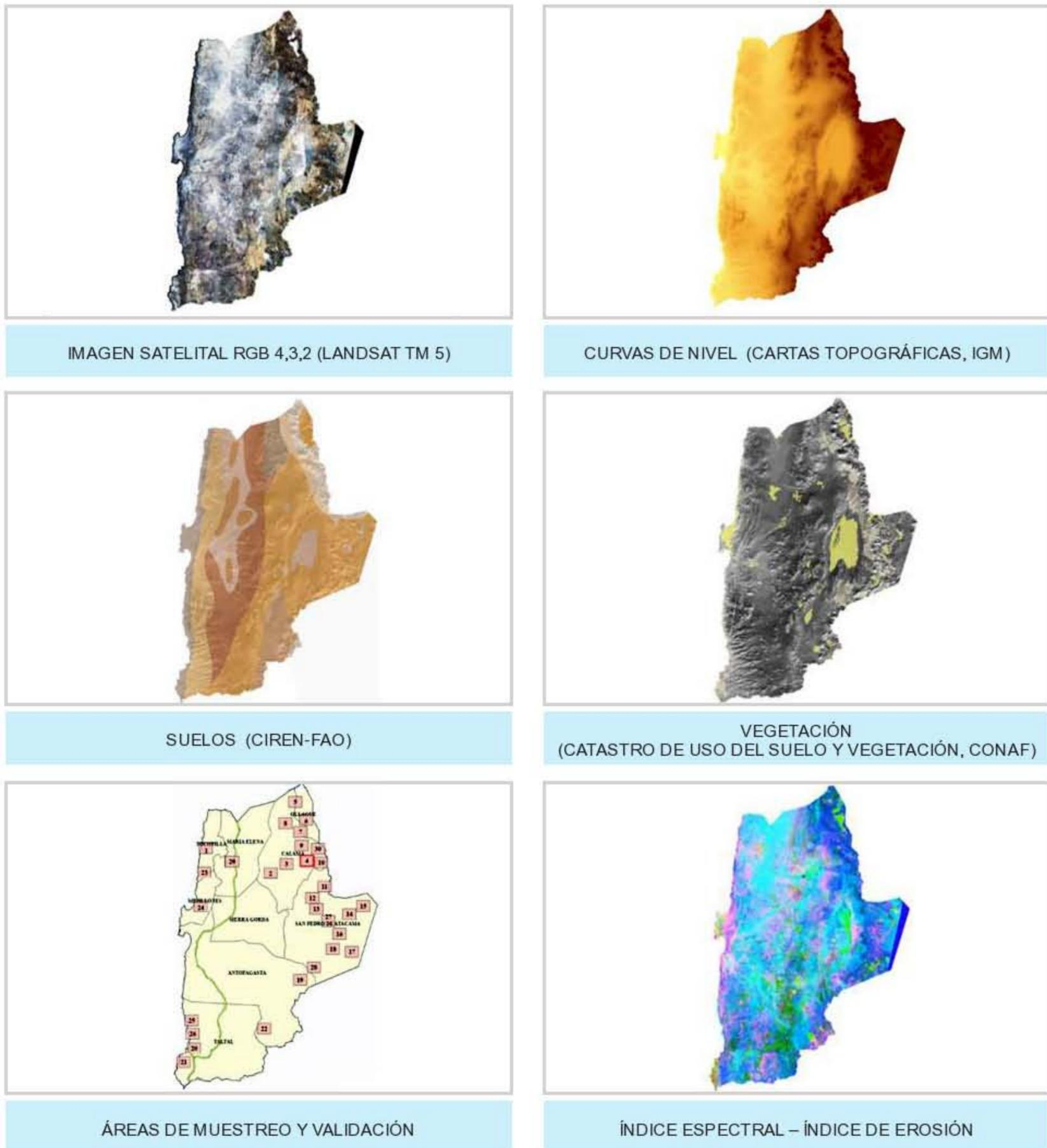
**Figura 9.** Cobertura de información biogeofísica para la determinación de la erosión actual en la Región de Antofagasta – modelo de erosión actual.
