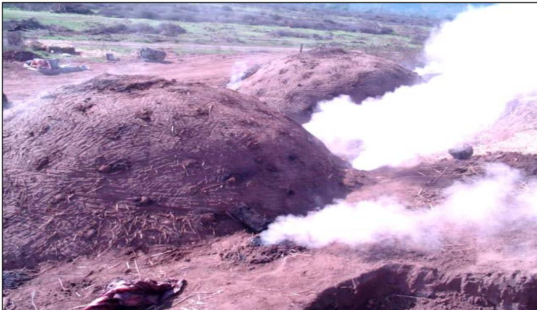
**Figura 15. Horno en proceso de enfriamiento**
