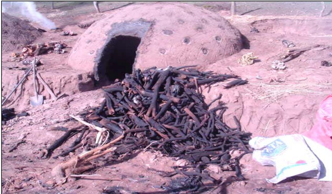
**Figura 14. Carga de tizón en el horno**
