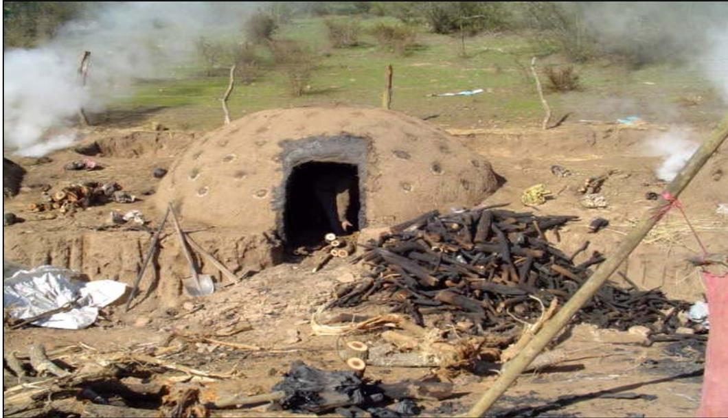
**Figura 16. Descarga del horno**
