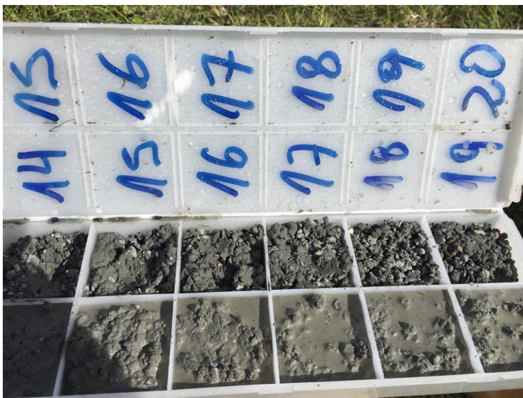
Figura 5.5 Muestras extraídas en uno de los sondajes realizados. Fuente: Elaboración propia.
