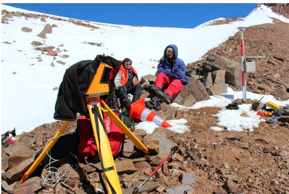
**Figura 13.** Mediciones con escáner ILRIS-LR en el punto TLS2. Atrás se ve la cámara automática con el jalón topográfico del DGPS
