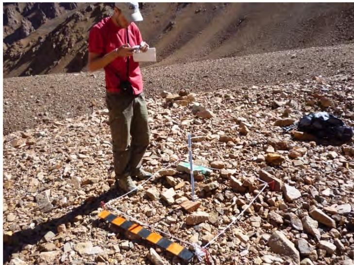
**Figura 27.** Protocolo utilizado en el terreno para las mediciones sedimentológicas: una parcela móvil de 1 m<sup>2</sup> está instalada alrededor del termistor.
