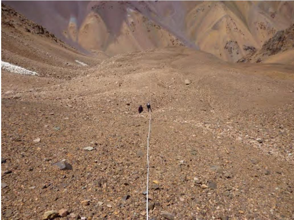
**Figura 23.** Materialización de los perfiles radar en el suelo con huinchas adjuntadas.
