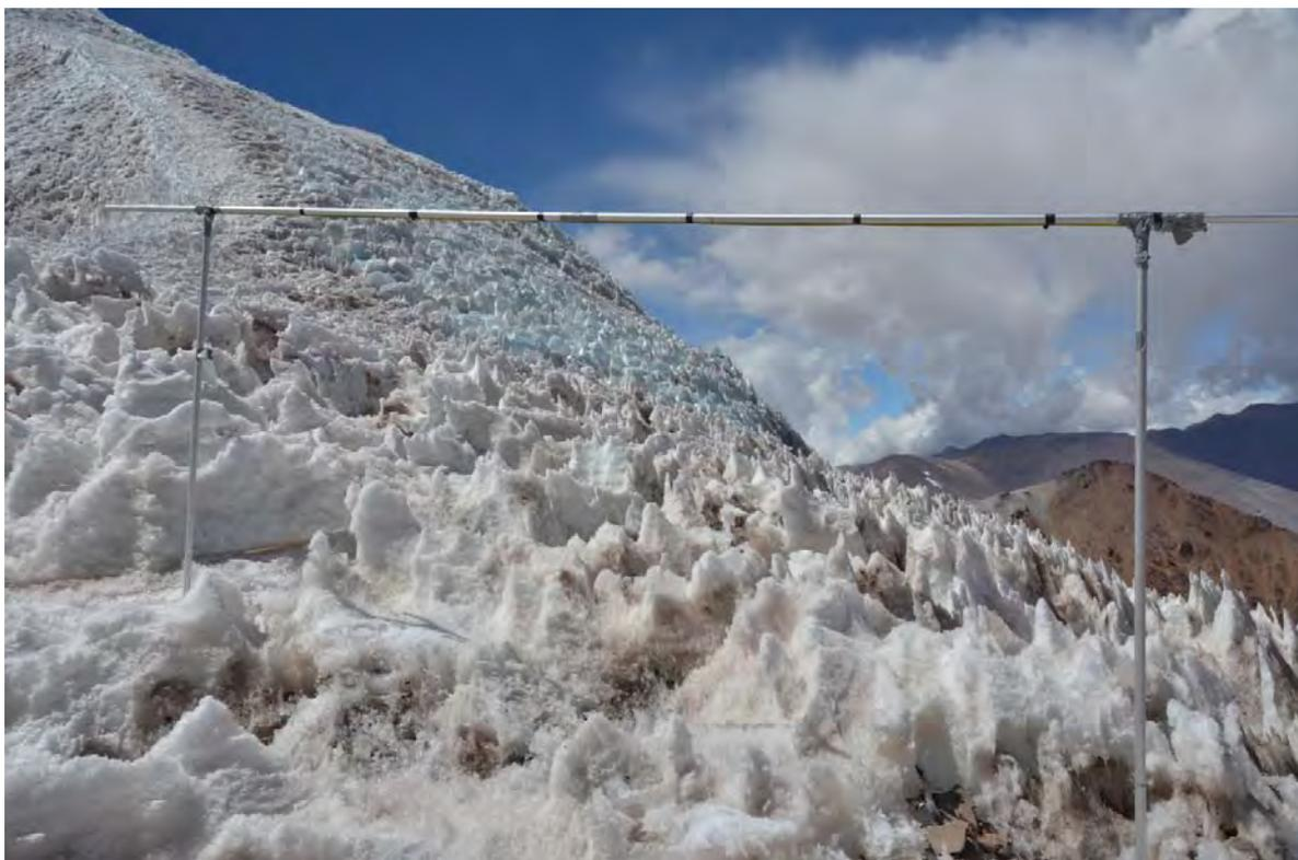
**Figura 10.** Ejemplo de arco de ablación instalado en la superficie del glaciar Tapado. El arco ('arco3') está ubicado en la parte media del glaciar. Foto: 22 de febrero de 2012.
