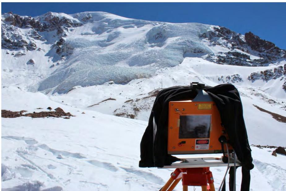
**Figura 12.** Mediciones con escáner ILRIS-LR en el punto TLS1.
