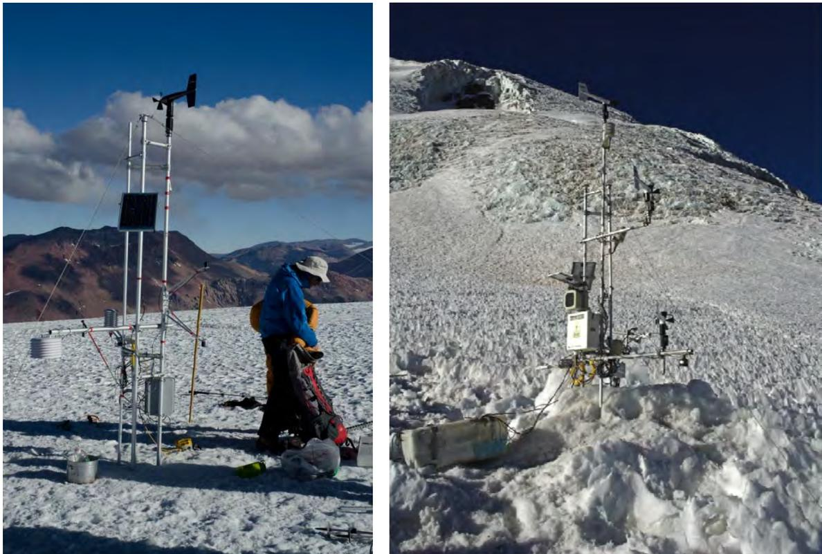
**Figura 16.** Fotos de las dos estaciones meteorológicas instaladas sobre el glaciar Tapado en noviembre de 2011. Izquierda: estación en la cumbre (EM1); derecha: estación en la zona de ablación (EM2).
