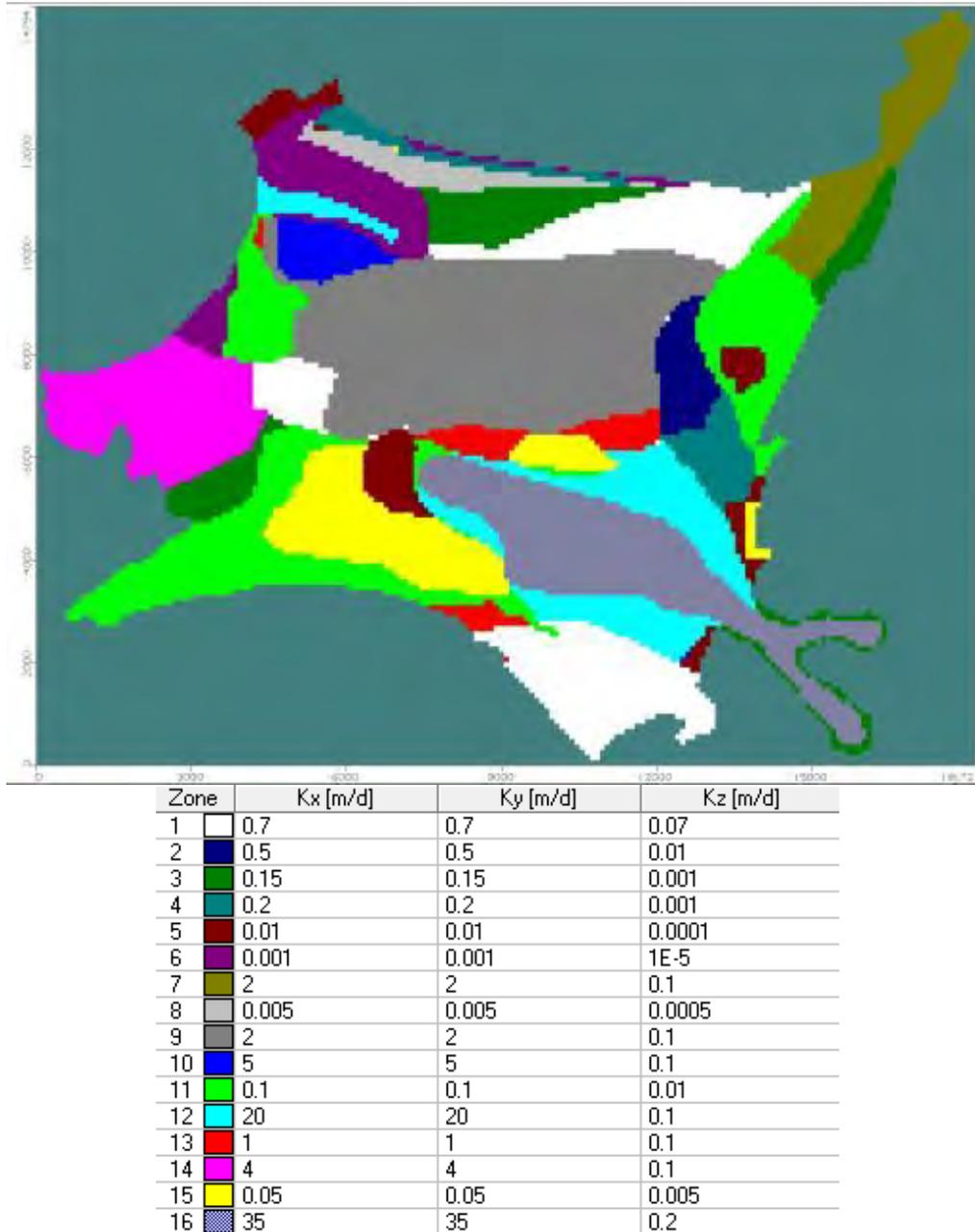
Figura 106. Permeabilidad obtenida tras calibración. Acuífero Talcahuano
