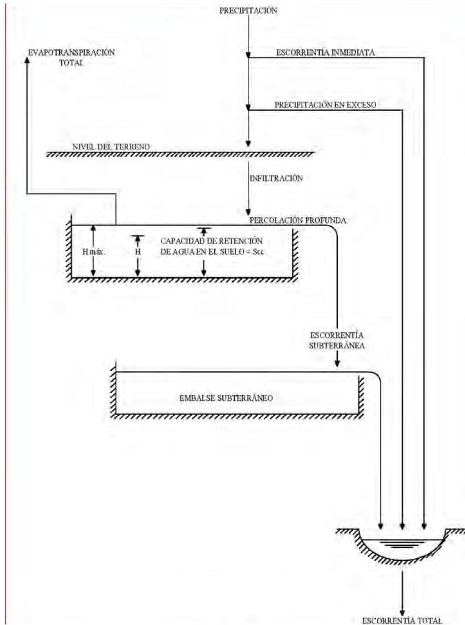
Figura 5. Esquema Conceptual del MPL
