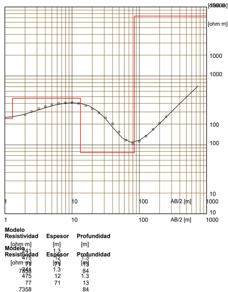
Figura 31. Inversión de sondeo eléctrico vertical SEV.
