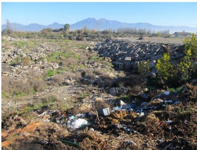
Ilustración 8: Vertedero Los Lirios, vista antiguo pozo de relleno con escombros.
