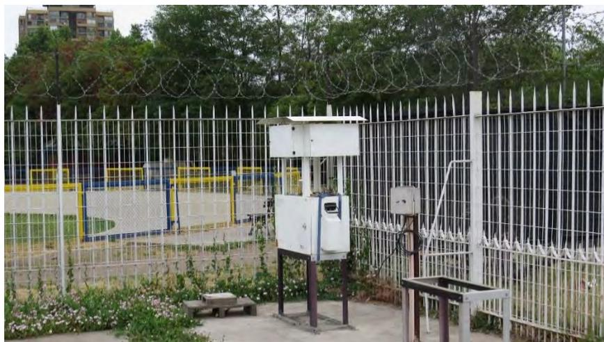
Figura 24: Equipo Low Vol, Partisol 2300-Speciation Sampler, Thermo.
