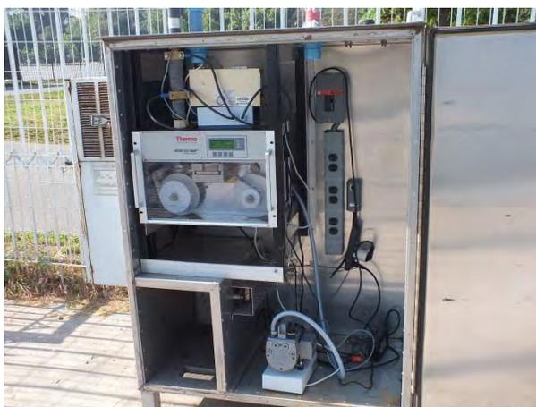
Figura 23: Equipo de monitoreo de Black Carbon - Multi Angle Absorption Photometer (MAAP) 5012, Thermo y equipo Espectrómetro Laser de Aerosoles, GRIMM.
