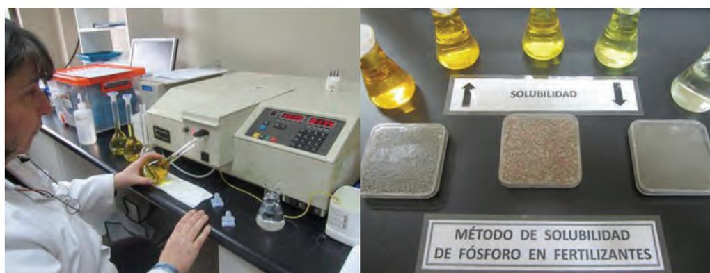
**Figura 11. Determinación del fósforo soluble en fertilizantes fosfatados extraído con solución de ácido cítrico al 2%, a través de la técnica colorimétrica del vanado molibdato en un espectrofotómetro UV-Visible.**
