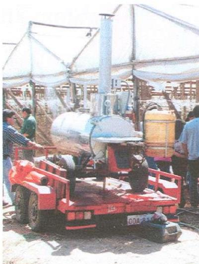
Foto 1. Vaporizador de fabricación nacional, apropiado para la inyección de vapor al suelo en invernaderos.
