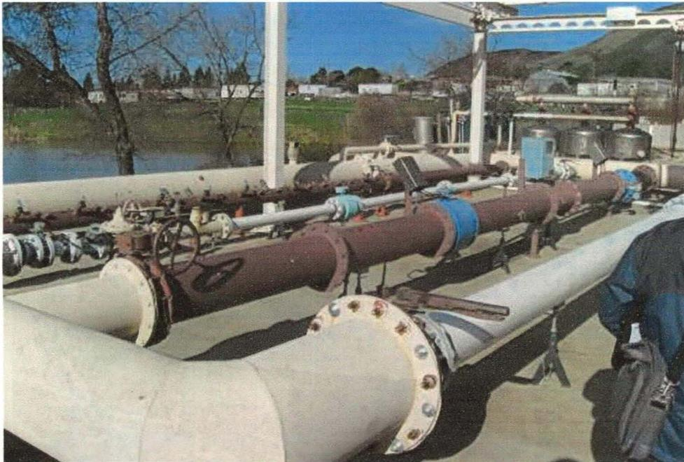
**Foto 19: Banco de pruebas de caudalímetros. Irrigation Training Research Center. California Polytechnic State University, San Luis Obispo, California.**
