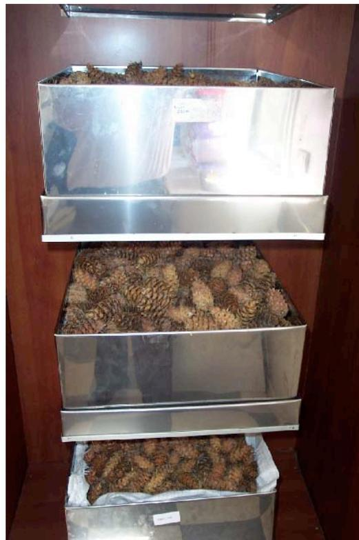
**Figura 89:** Horno de Secado. Proceso para secado de conos de pino oregon (aproximadamente 72 horas a 48 °C.)
