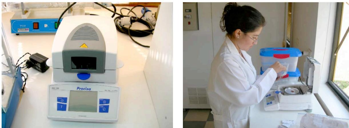
**Figura 56:** Balanza digital con capacidad de determinar contenido de humedad, adquirida para complementar el equipamiento del laboratorio de semillas implementado por el proyecto.
