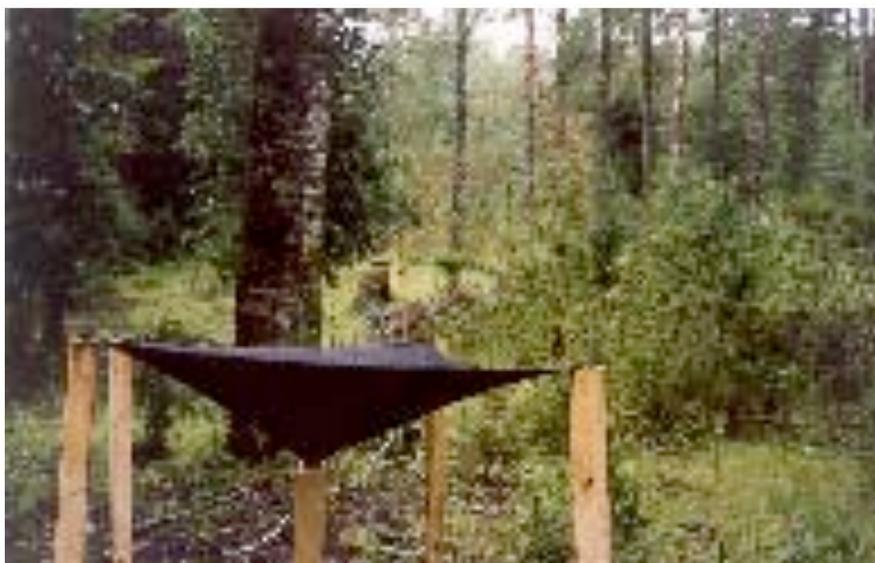
**FIGURA 2:** Colector para Muestreo
