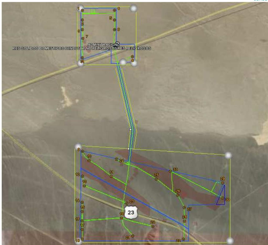
Fig. 1. Área prospectada (en verde) en relación a los polígonos propuestos para la obra (en azul), instalación de Aerogeneradores, caminos y cableado.
