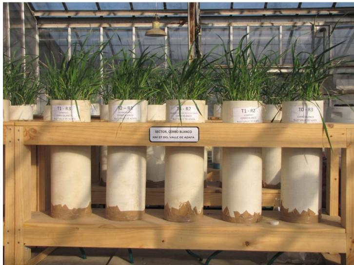
**Foto 8.** Ensayo de columnas de lixiviación ya establecido.
