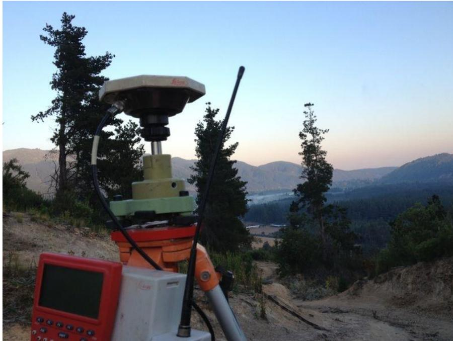
**Foto 7.3-1** *Receptores GNSS empleados*
