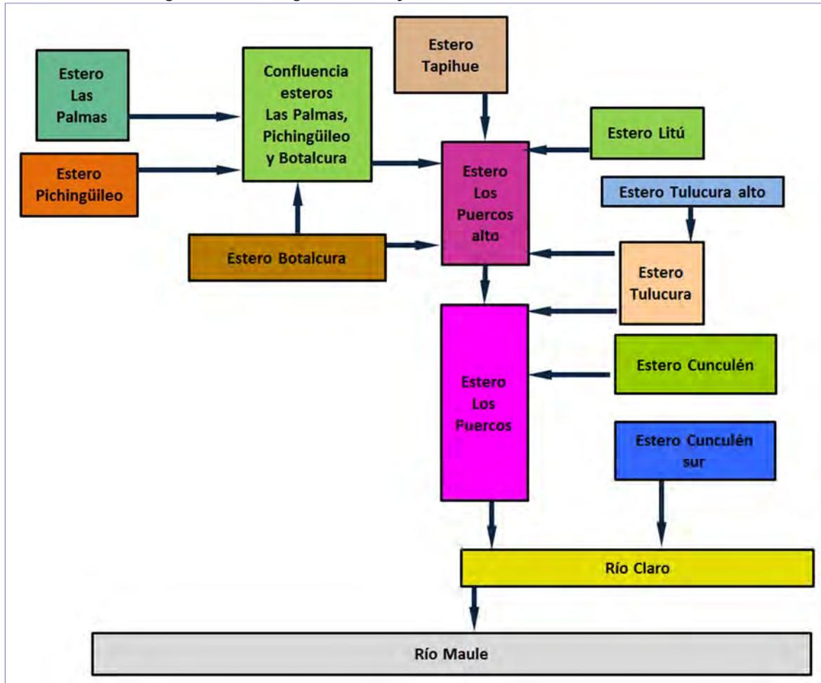
Figura VII-3. Esquema del modelo conceptual del flujo en el área de estudio
