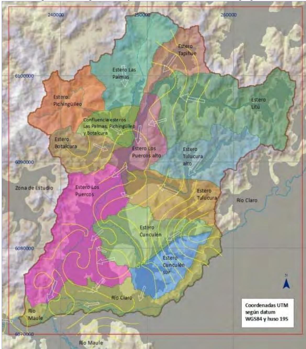
Figura VII-2. Diagrama de flujo subterráneo sistema Pencahue
