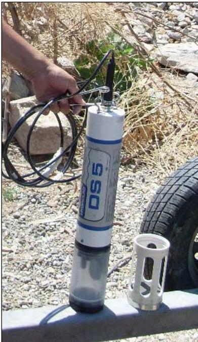
**Figura 13.** Sonda Multiparamétrica.
