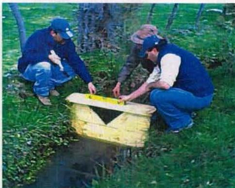
**Imagen N° 12: Instructor ayudando a la nivelación del vertedero triangular instalado en el canal**
