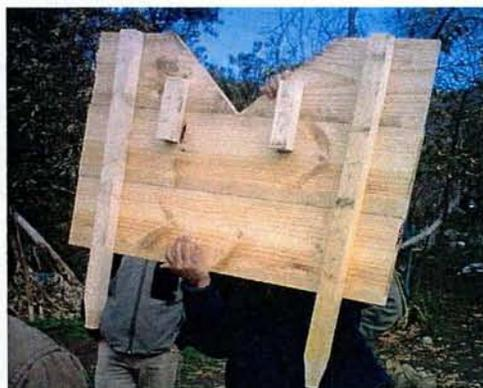
**Imagen N° 11: Vertedero triangular listo para ser instalado.**
