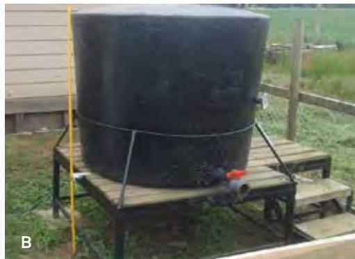
**Figura 15 (A-B):** Biodigestor de estructura rígida y gasómetro externo.
