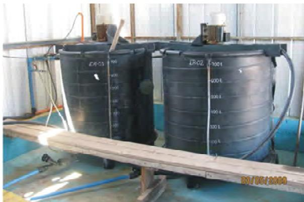
**Foto 19.** agitador de fertilizantes a través de aspas en tanques inyector.
