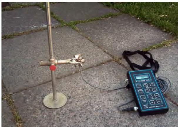
**Figura 26.** Molinete hidráulico.
