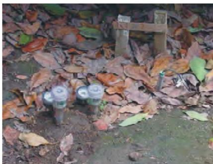
**Foto 30.** Tensiómetros instalados en palto.
