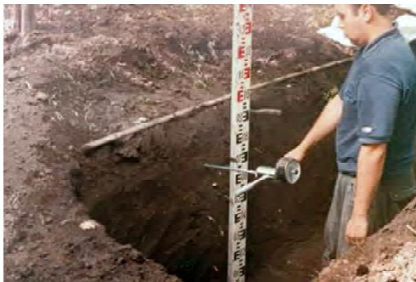
**Foto 3.** Medición de la resistencia mecánica con penetrómetro.
