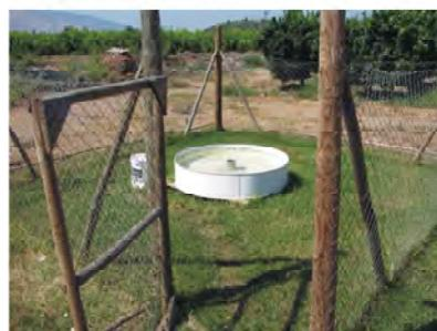
**Figura 19.** Bandeja de evaporación Clase A.
