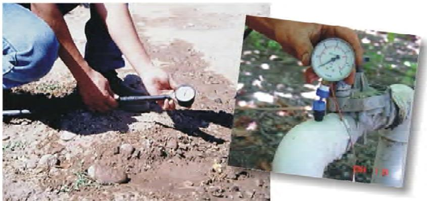
**Foto 22.** Medición de presión al final del lateral y en la válvula del sector de riego.
