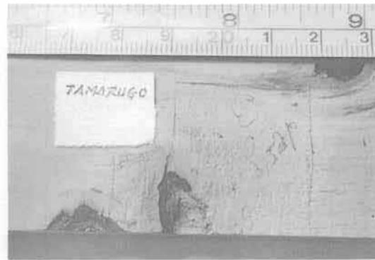
FOTO 4: Tamarugo. (efecto de la inclinación de fibras en zona adyacente a los nudos). Defecto: grano desgarrado grado 2.
