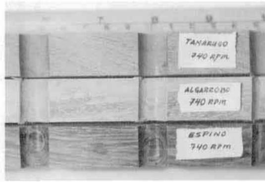
FOTO 8: Taladrado. Tamarugo, algarrobo y espino bajo una velocidad de rotación de 740 r.p.m.
