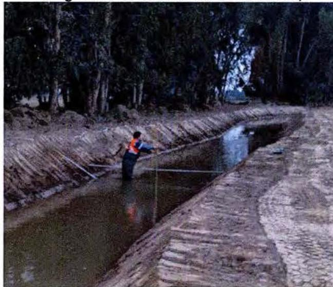
Al analizarse de manera global el canal, se obtiene que la pérdida total en éste, obtenida de forma acumulativa en cada sección sobre la pérdida acumulada hasta la sección anterior, alcanza hasta un 73,8% del caudal entrante en la bocatoma. Cabe agregar que el canal prácticamente en toda su extensión no se encuentra revestido y presenta una acumulación considerable de algas, lo que incide en los altos índices de pérdidas por infiltración.
