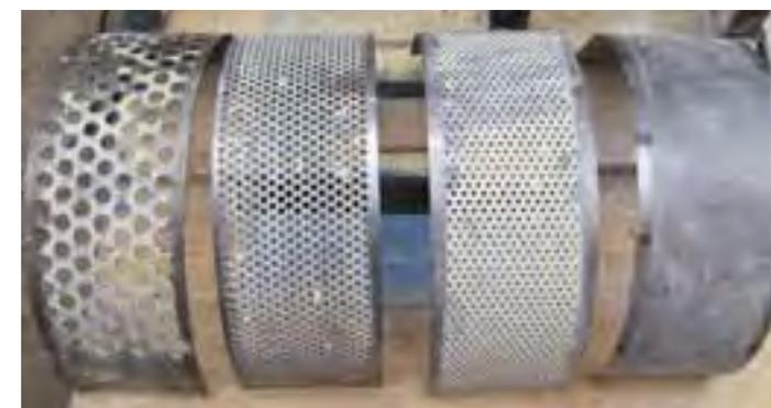
Figura 43. Cribas Utilizadas para Molienda
