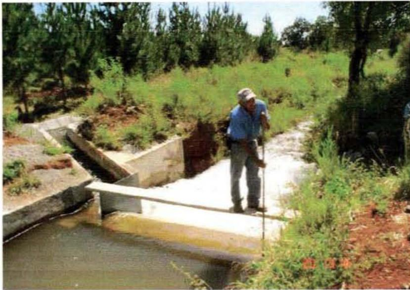
*Figura 2:* Aforo de canal, sección regular.
