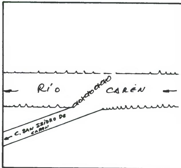
DESCRIPCION DE LA BOCATOMA Con barrera de piedras y patas de cabras se desvía un brazo del río hacia la bocatoma del canal, de tipo provisoria, frente al predio rol 423-92 de Illapel.
