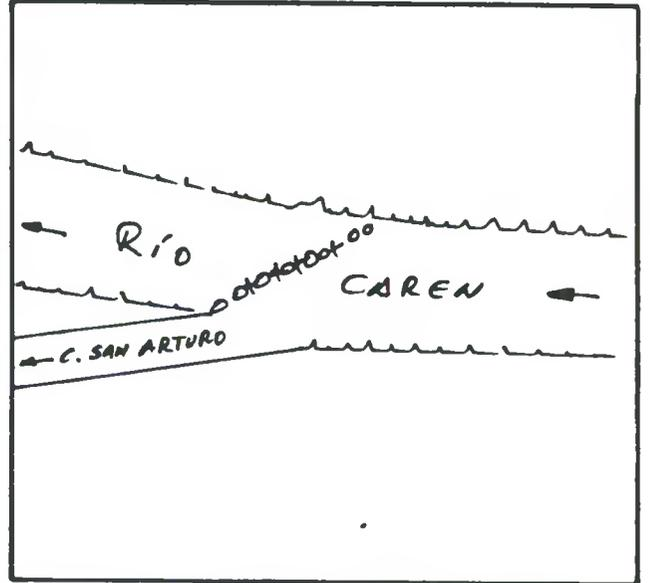
DESCRIPCION DE LA BOCATOMA Con barrera de piedras y patas de cabras se desvía un brazo del río hacia la bocatoma del canal, de tipo provisoria, frente al predio rol 423-123 de Illapel.
