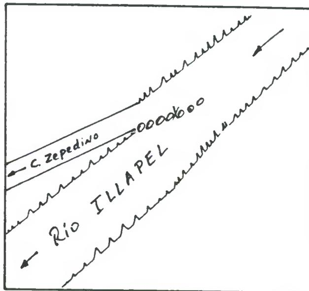
DESCRIPCION DE LA BOCATOMA Con barrera de piedras y patas de cabras se desvía un brazo del río hacia la bocatoma del canal, de tipo, provisoria, frente al predio rol 415-8 de Illapel.
