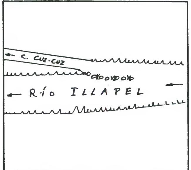
DESCRIPCION DE LA BOCATOMA Con barrera de piedras y patas de cabras se desvía un brazo del río hacia la bocatoma del canal, de tipo provisoria, frente a la estación de ferrocarril de la ciudad de Illapel.
