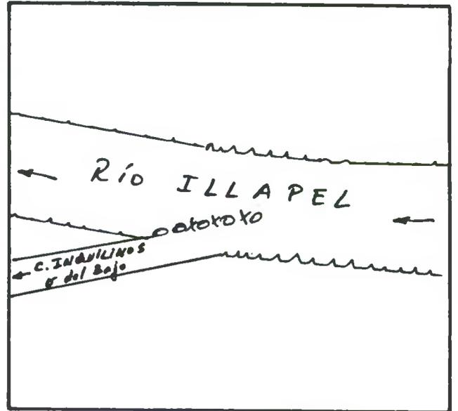
DESCRIPCION DE LA BOCATOMA Con barrera de piedras y patas de cabras se desvía un brazo del río hacia la bocatoma del canal, de tipo provisoria, frente al predio rol 427-38 de Illapel.
