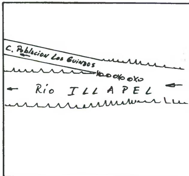
DESCRIPCION DE LA BOCATOMA Con barrera de piedras y patas de cabras se desvía un brazo del río hacia la bocatoma del canal, de tipo provisoria, frente al predio rol VP-1-D5 de Illapel.
