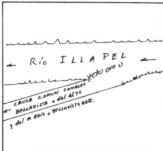
DESCRIPCION DE LA BOCATOMA Con barrera de piedras y patas de cabra se desvía un brazo del río hacia la bocatoma del canal, de tipo provisoria, frente al predio rol 432-1B de Illapel.
