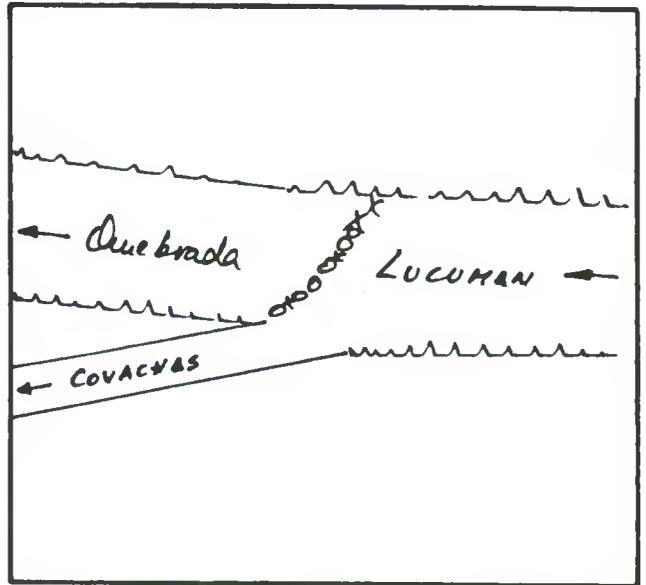
DESCRIPCION DE LA BOCATOMA Con barrera de piedras y patas de cabras se desvía un brazo del río hacia la bocatoma del canal, de tipo provisoria, frente al predio rol 423-104 de Illapel.
