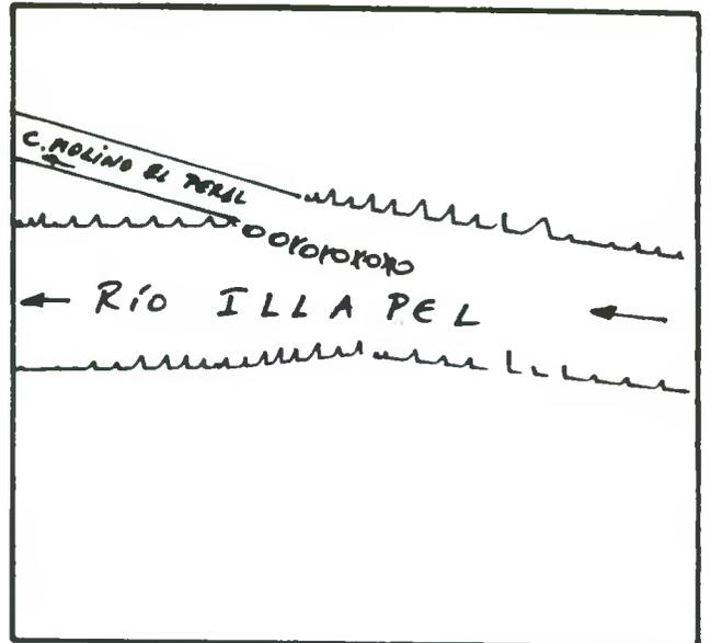
DESCRIPCION DE LA BOCATOMA Con barrera de piedras y patas de cabras se desvía un brazo del río hacia la bocatoma del canal, de tipo, provisoria, frente al predio rol E.T. de Illapel, frente a la ex Estación de Cuz Cuz.
