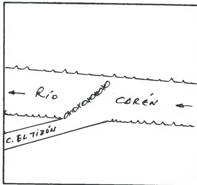
DESCRIPCION DE LA BOCATOMA Con barrera de piedras y patas de cabras se desvía un brazo del río hacia la bocatoma del canal, de tipo provisoria, frente al predio rol 423-93 de Illapel.
