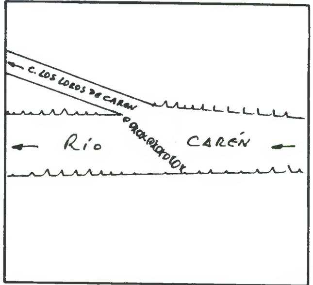
DESCRIPCION DE LA BOCATOMA Con barrera de piedras y patas de cabras se desvía un brazo del río hacia la bocatoma del canal, de tipo provisoria, frente al predio rol 423-93 de Illapel.
