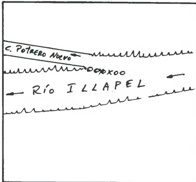
DESCRIPCION DE LA BOCATOMA Con barrera de piedras y patas de cabra se desvía un brazo del río hacia la bocatoma del canal, de tipo provisoria, frente al predio rol 433-30-A de Illapel.
