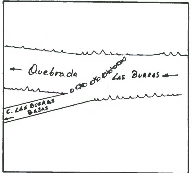
DESCRIPCION DE LA BOCATOMA Con barrera de piedras y patas de cabras se desvía un brazo del río hacia la bocatoma del canal, de tipo provisoria, frente al predio rol 423-110 de Illapel.
