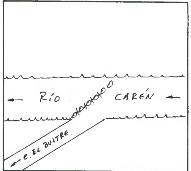
DESCRIPCION DE LA BOCATOMA Con barrera de piedras y patas de cabras se desvía un brazo del río hacia la bocatoma del canal, de tipo provisoria, frente al predio rol 423-91 de Illapel.
