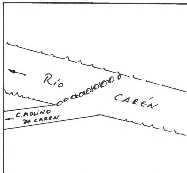
DESCRIPCION DE LA BOCATOMA Con barrera de piedras y patas de cabras se desvía un brazo del río hacia la bocatoma del canal, de tipo provisoria, frente al predio rol 423-91 de Iilapel.
