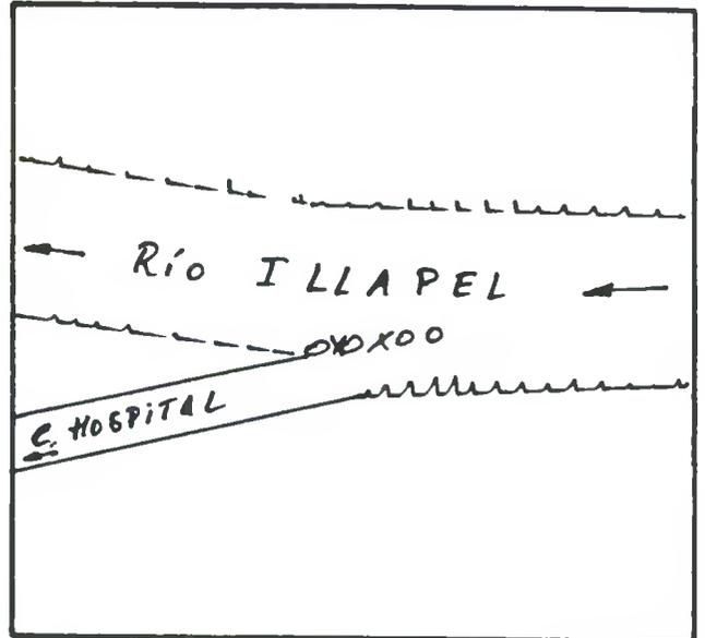
DESCRIPCION DE LA BOCATOMA Con barrera de piedras y patas de cabra se desvía un brazo del río hacia la bocatoma del canal, de tipo provisoria, frente al predio rol 433-44 de Illapel.
