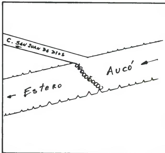
DESCRIPCION DE LA BOCATOMA Con barrera de piedras y patas de cabras se desvía un brazo del río hacia la bocatoma del canal, de tipo provisoria, frente al predio rol 431-23-C de Illapel.
