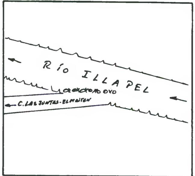
DESCRIPCION DE LA BOCATOMA Con barrera de piedras y patas de cabras se desvía un brazo del río hacia la bocatoma del canal, de tipo provisoria frente al predio rol 427-25 de Illapel.
