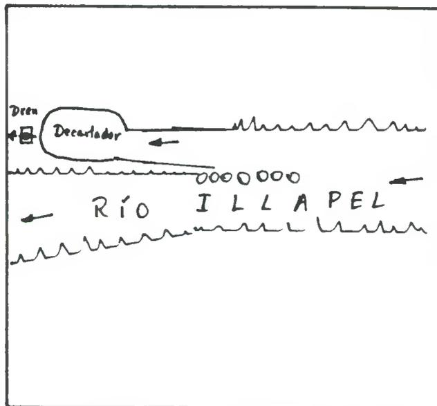
DESCRIPCION DE LA BOCATOMA Con barrera de piedras y patas de cabra se desvía un brazo del río hacia la bocatoma del canal, de tipo provisoria, frente al predio rol 432-14 de Illapel.
