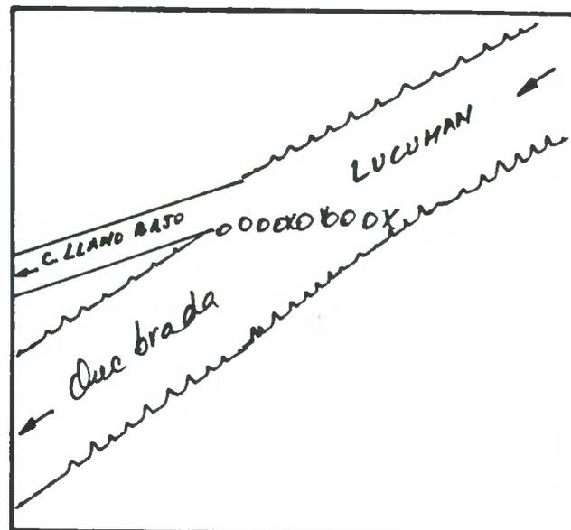
DESCRIPCION DE LA BOCATOMA Con barrera de piedras y patas de cabras se desvía un brazo del río hacia la bocatoma del canal, de tipo provisorio, frente al predio rol 423-105 de Illapel.
