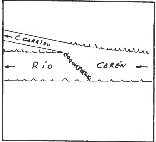
DESCRIPCION DE LA BOCATOMA Con barrera de piedras y patas de cabras se desvía un brazo del río hacia la bocatoma del canal, de tipo provisoria, frente al predio rol 423-123 de Iliapel.
