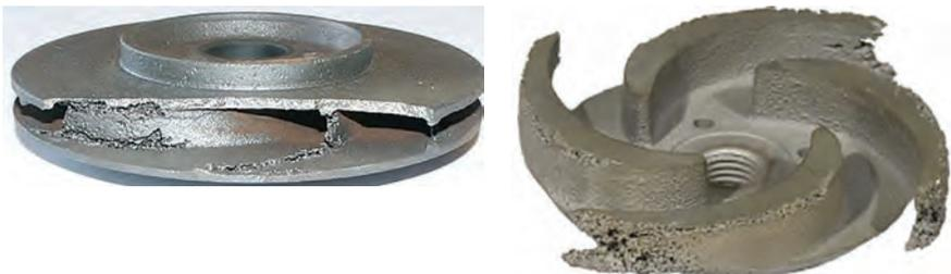
ebullición se produce cuando la presión de vapor del líquido se iguala a la presión ambiente, mientras que la cavitación se produce por una caída de la presión local por debajo de la presión de vapor.
