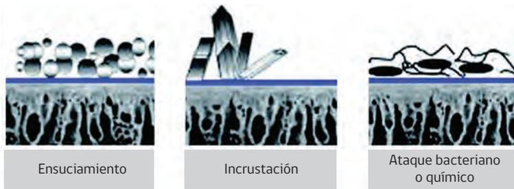
**Figura 4.19.** Fotografías de membranas afectadas por ensuciamiento (del Vigo et al. 2012; WaterTech, 2021; Telwesa, 2019; Acondicionamientos, 2021).
