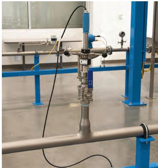
La medición del pH en desalación de aguas es muy importante, debido a que algunos procesos químicos solamente pueden tener lugar a un determinado pH. Por ejemplo, las reacciones del cloro (pre y postratamiento) se verifican cuando el pH se encuentra entre 6,5 y 8. Además, el pH sirve como un indicador del tipo de especiación que tienen determinados iones en agua. Así, por ejemplo, el boro
