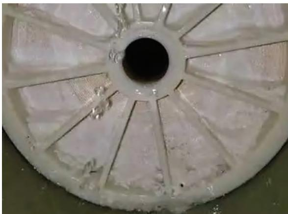
las incrustaciones de carbonato cálcico aceleran la hidrólisis provocando un aumento en el paso de sales.
