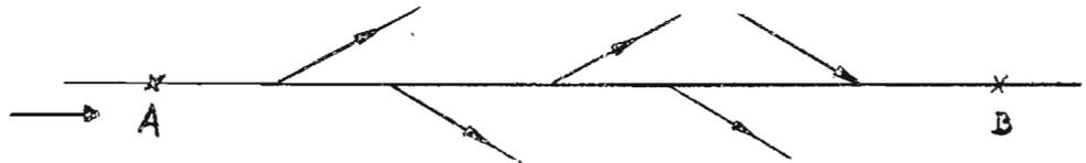
La primera etapa consiste en aforar el gasto de entrada en A. A continuación mediante el trabajo en paralelo de dos equipos de aforadores (una camioneta por cada orilla), se van midiendo todos los saques y entradas al río, tratando de ir a una velocidad comparable a la del agua. Finalmente se cierra el tramo AB determinando el gasto de salida en B. Así se tiene que:
