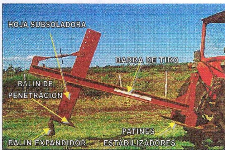
Fotografía 2. Prototipo de Arado Topo y sus componentes.
