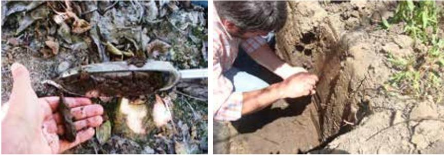
**Figura 5.6.** Monitoreo de humedad de suelo mediante barreno y calicatas.
