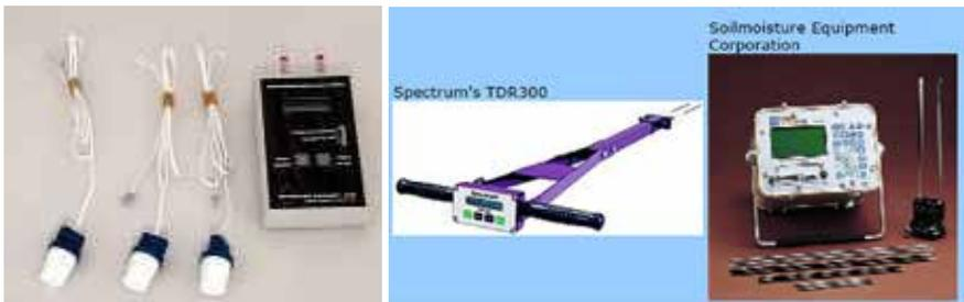
**Figura 5.5.** (Izquierda) Bloques de yeso. (Derecha). Sensores de capacitancia.
