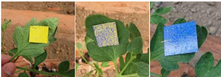
**Figura 8.5.** Uso de papeles hidrosensibles para comprobación de cubrimiento. (Izquierda) Pulverización deficiente. (Centro) Pulverización óptima. (Derecha) Pulverización excesiva.
