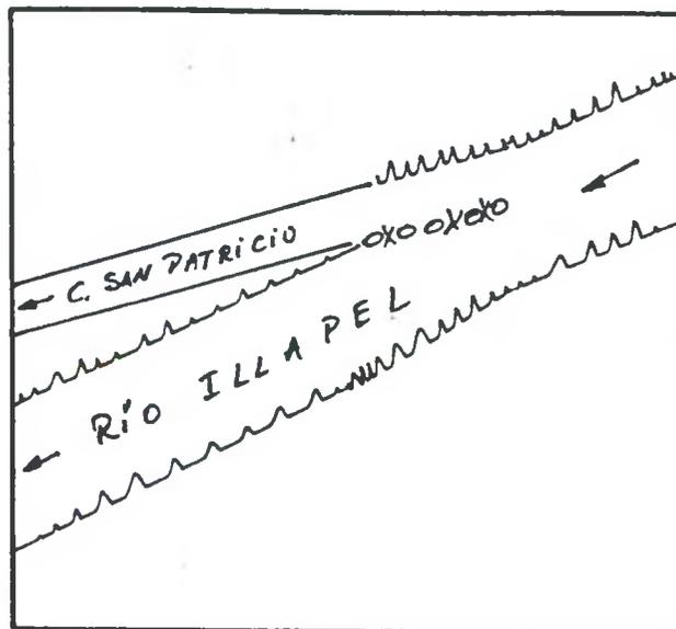
DESCRIPCION DE LA BOCATOMA Con barrera de piedras y patas de cabra se desvía un brazo del río hacia la bocatoma del canal, de tipo provisoria, frente al predio rol 423-10 de Illapel.
