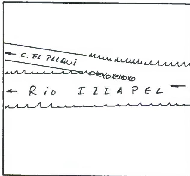
DESCRIPCION DE LA BOCATOMA Con barrera de piedras y patas de cabra se desvía un brazo del río hacia la bocatoma del canal, de tipo provisoria, frente al predio rol 423-123 de Illapel.
