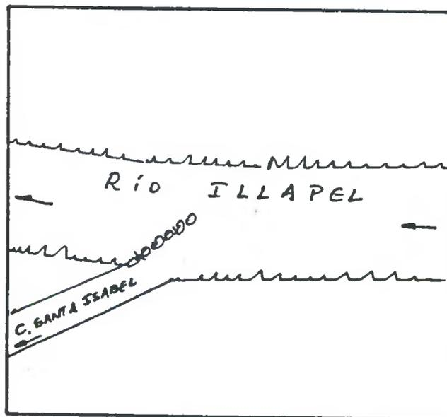
DESCRIPCION DE LA BOCATOMA Con barrera de piedras y patas de cabra se desvía un brazo del río hacia la bocatoma del canal, de tipo provisoria, frente al predio rol 423-68 de Illapel.
