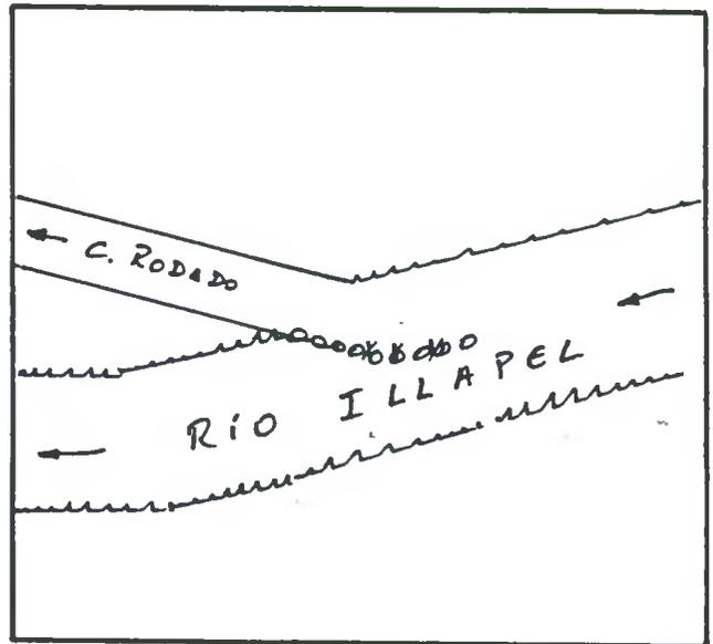
DESCRIPCION DE LA BOCATOMA Con barrera de piedras y patas de cabra se desvía un brazo del río hacia la bocatoma del canal, de tipo provisoria, frente al predio rol 423-101 de Illapel,
