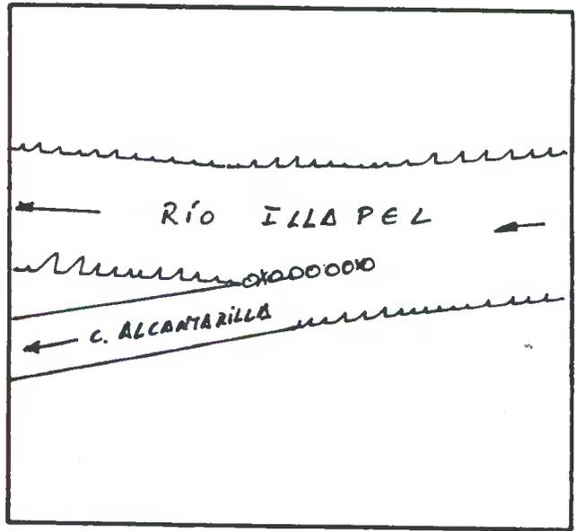
DESCRIPCION DE LA BOCATOMA Con barrera de piedras y patas de cabra se desvía un brazo del río hacia la bocatoma del canal, de tipo provisoria, frente al predio rol 423-108-A de Illapel.
