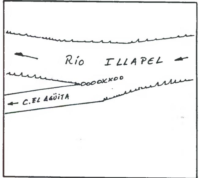
DESCRIPCION DE LA BOCATOMA Con barrera de piedras y patas de cabra se desvía un brazo del río hacia la bocatoma del canal, de tipo provisoria, frente al predio rol 423-109 de Illapel.
