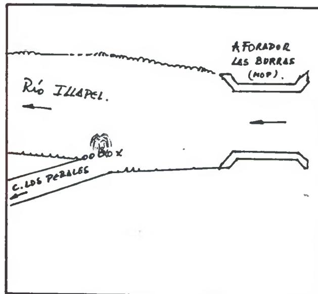
DESCRIPCION DE LA BOCATOMA Con barrera de piedras y patas de cabra se desvía un brazo del río hacia la bocatoma del canal, de tipo provisoria, frente al predio rol 423-112 de Illapel.
