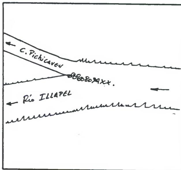
DESCRIPCION DE LA BOCATOMA Con barrera de piedras y patas de cabra se desvía un brazo del río hacia la bocatoma del canal, de tipo provisoria, frente al predio rol 423-112 de Illapel.
