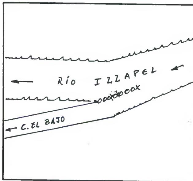
DESCRIPCION DE LA BOCATOMA Con barrera de piedras y patas de cabra se desvía un brazo del río hacia la bocatoma del canal, de tipo provisoria, frente al predio rol 423-103 de Illapel.
