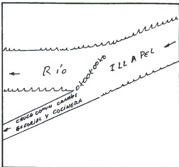
DESCRIPCION DE LA BOCATOMA Con barrera de piedras y patas de cabra se desvía un brazo del río hacia la bocatoma del canal, de tipo provisoria, frente al predio rol 423-51 de Illapel.
