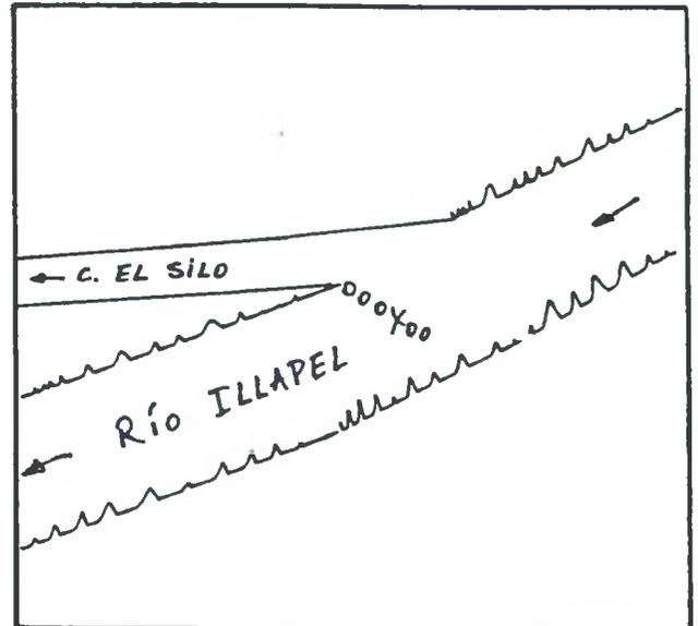
DESCRIPCION DE LA BOCATOMA Con barrera de piedras y patas de cabras se desvía un brazo del río hacia la bocatoma del canal, de tipo provisoria, frente al predio rol 423-12 de Illapel.
