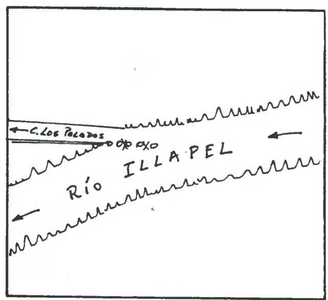
**DESCRIPCION DE LA BOCATOMA** Con barrera de piedras y patas de cabra se desvía un brazo del río hacia la bocatoma del canal, de tipo provisoria, frente al predio rol 423-20 de Illapel.
