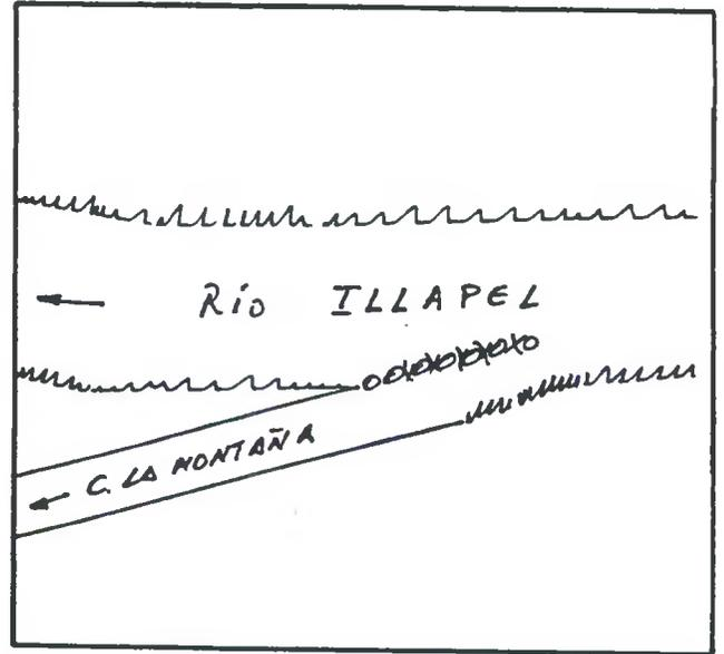
DESCRIPCION DE LA BOCATOMA Con barrera de piedras y patas de cabra se desvía un brazo del río hacia la bocatoma del canal, de tipo provisoria, frente al predio rol 423-98 de Illapel.
