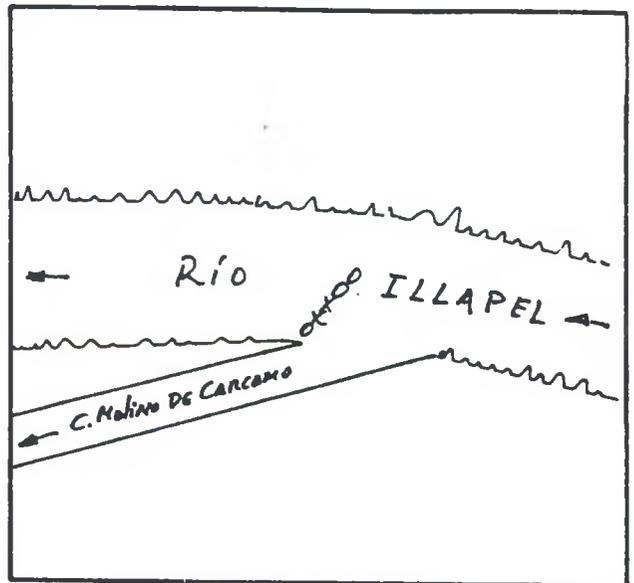
DESCRIPCION DE LA BOCATOMA Con barrera de piedras y patas de cabra se desvía un brazo del río hacia la bocatoma del canal, de tipo provisoria, frente al predio rol 433-18 de Illapel.
