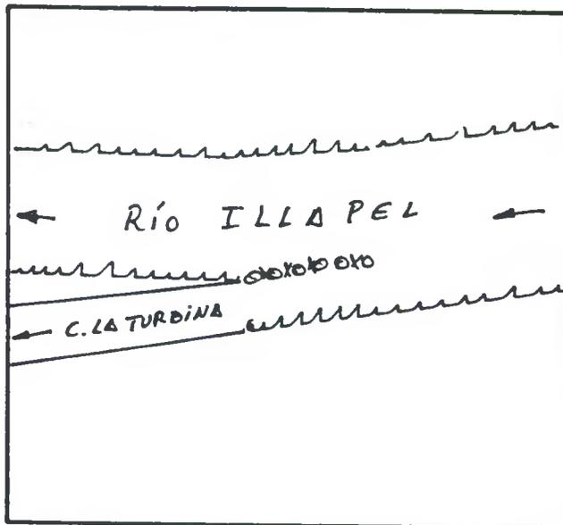
DESCRIPCION DE LA BOCATOMA Con barrera de piedras y patas de cabra se desvía un brazo del río hacia la bocatoma del canal, de tipo provisoria, frente al predio rol 423-73 de Illapel.
