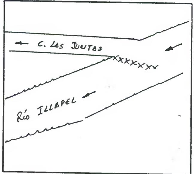
DESCRIPCION DE LA BOCATOMA Con barrera de piedras y patas de cabra se desvía un brazo del río hacia la bocatoma del canal, de tipo provisoria, frente al predio rol 423-120 de Illapel.
