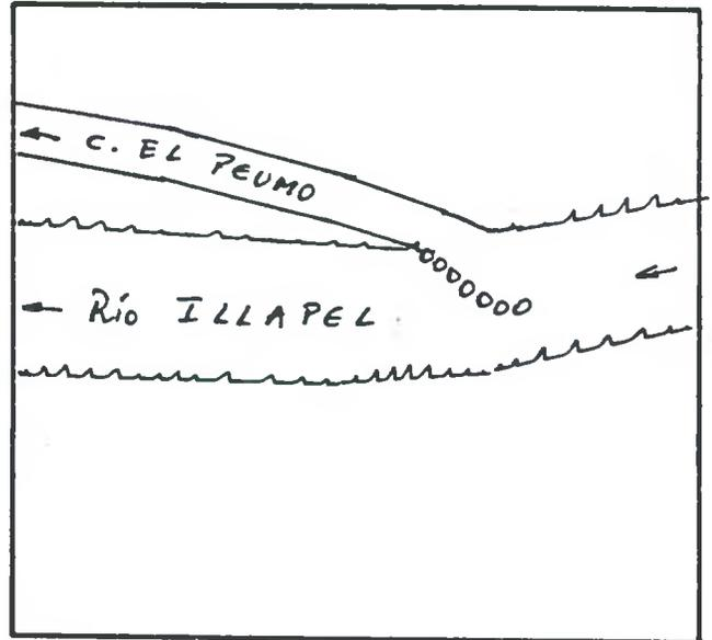
DESCRIPCION DE LA BOCATOMA Con barrera de piedras y patas de cabra se desvía un brazo del río hacia la bocatoma del canal, de tipo provisoria, frente al predio rol 423-123 de Illapel.
