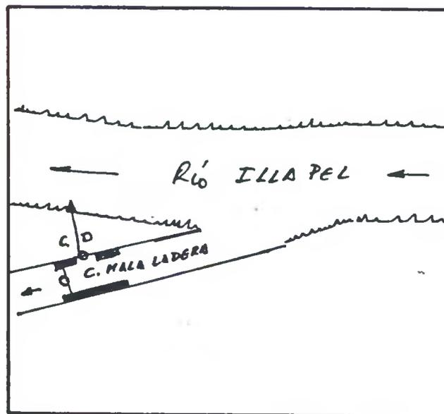
DESCRIPCION DE LA BOCATOMA Con barrera de piedras y patas de cabra se desvía un brazo del río hacia la bocatoma del canal, de tipo provisoria, frente al predio rol 423-109 de Illapel.
