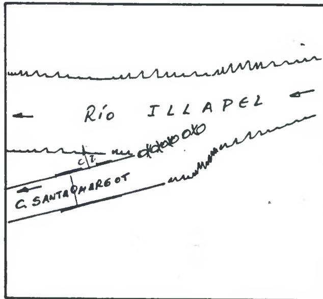
DESCRIPCION DE LA BOCATOMA Con barrera de piedras y patas de cabra se desvía un brazo del río hacia la bocatoma del canal, de tipo provisoria, frente al predio rol 423-100 de Illapel.
