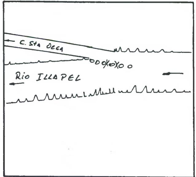
DESCRIPCION DE LA BOCATOMA Con barrera de piedras y patas de cabra se desvia un brazo del rio hacia la bocatoma del canal, de tipo provisoria, frente al predio rol 423-20 de Illapel.
