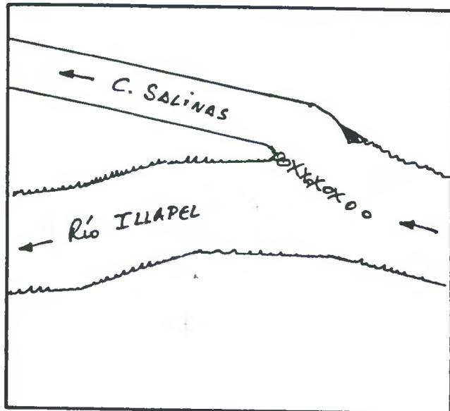
DESCRIPCION DE LA BOCATOMA Con barrera de piedras y patas de cabra se desvía un brazo del río hacia la bocatoma del canal, de tipo provisoria, frente al predio rol 423-114 de Illapel.
