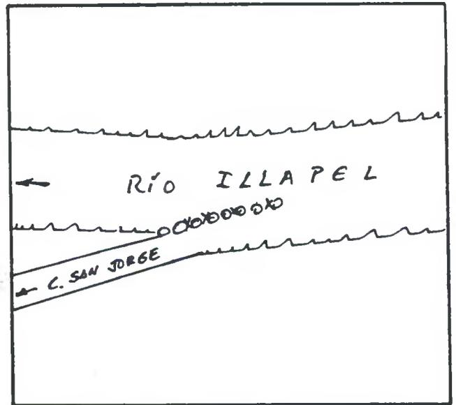
DESCRIPCION DE LA BOCATOMA Con barrera de piedras y patas de cabra se desvía un brazo del río hacia la bocatoma del canal, de tipo provisoria, frente al predio rol 423-72 de Illapel.
