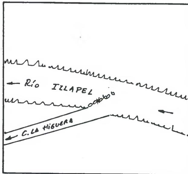
DESCRIPCION DE LA BOCATOMA Con barrera de piedras y patas de cabra se desvía un brazo del río hacia la bocatoma del canal, de tipo provisoria, frente al predio rol 433-2 de Illapel.
