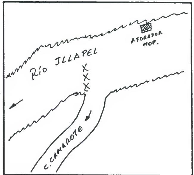
DESCRIPCION DE LA BOCATOMA Con barrera de piedras y patas de cabra se desvía un brazo del río hacia la bocatoma del canal, de tipo provisoria, frente al predio rol 423-51 de Illapel.
