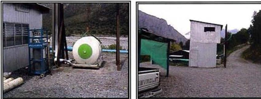
**Foto 24: Máquina contadora de peces y estanque cabecera 2º galpón.**
