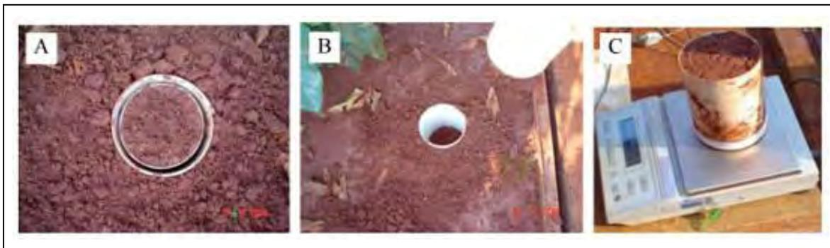
**Figura-2 Microlisímetro de balanza (Flumingnan et al., 2012)**
