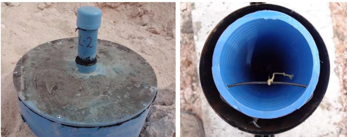
**Figura-12: Instalación del Dipper APT y sellado de tapa de estanque (izquierda). Sistema de soporte del Dipper APT.**
