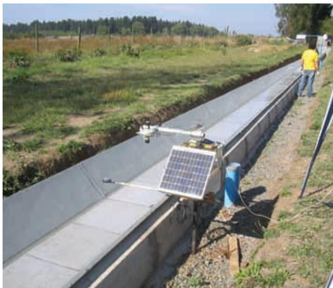
realizaron pruebas de laboratorio en reactores estáticos de bajo volumen y de recirculación, además de pruebas en condiciones de operación controladas en un canal prototipo de 104 m en longitud.
