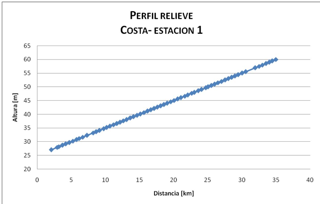
**Figura 4.6** Perfil del relieve del terreno que une la toma de agua y la estación uno
