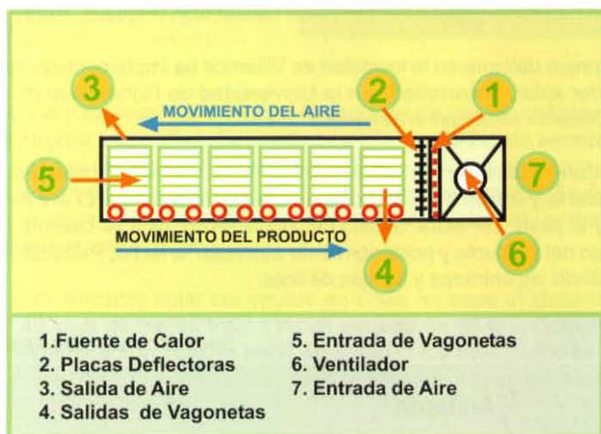
Secadero de túnel contracorriente (fuente: herbotecnia.com.ar)
