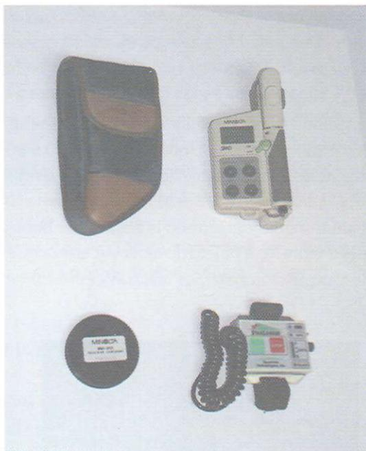
Figura 1. Equipo completo del Medidor de Clorofila. (Estuche, Instrumento, Filtro de calibración y Complemento para conexión digital).
