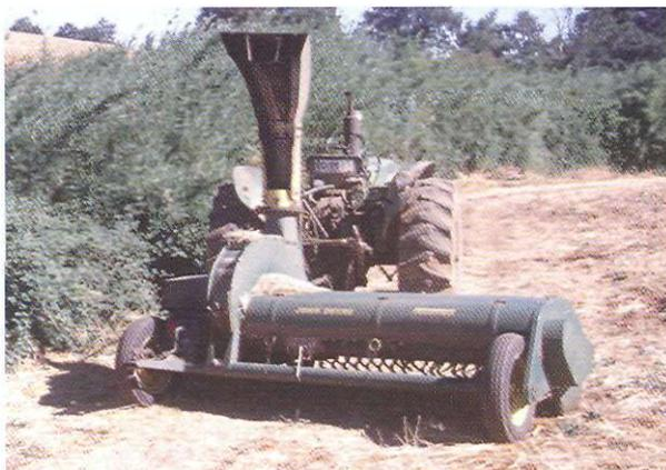
Foto 6. Picadora de forraje, adaptada para el manejo de los rastrojos.
