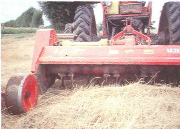
Foto 5. Máquina trituradora de rastrojos accionada por el TDF del Tractor.
