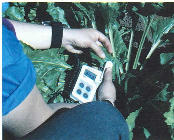
Figura 5. Utilización del medidor de clorofila a un tercio de la distancia desde la base en remolacha.
