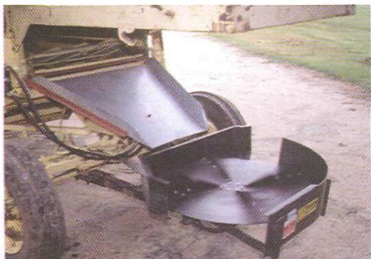
Foto 3. Esparcidor de residuos tipo molinete, que sólo esparce los residuos que provienen de las zarandas de limpieza y los sacapajas de la cosechadora automotriz.
