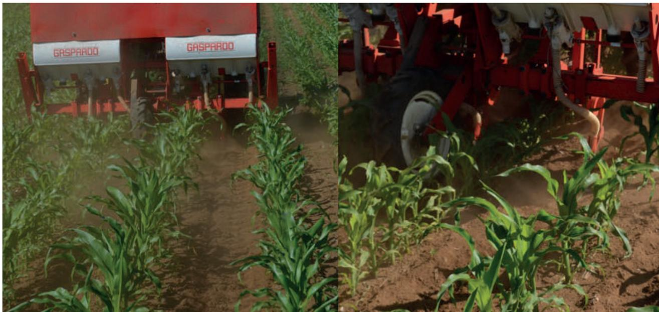
La aplicación del nitrógeno se realiza al momento de la aporca incorporando el nitrógeno en el centro de la entre hilera o sobre el suelo con implementos aporcadores. Es necesario el uso de ruedas de trocha angosta para evitar pérdidas por aplastamiento de plantas.
