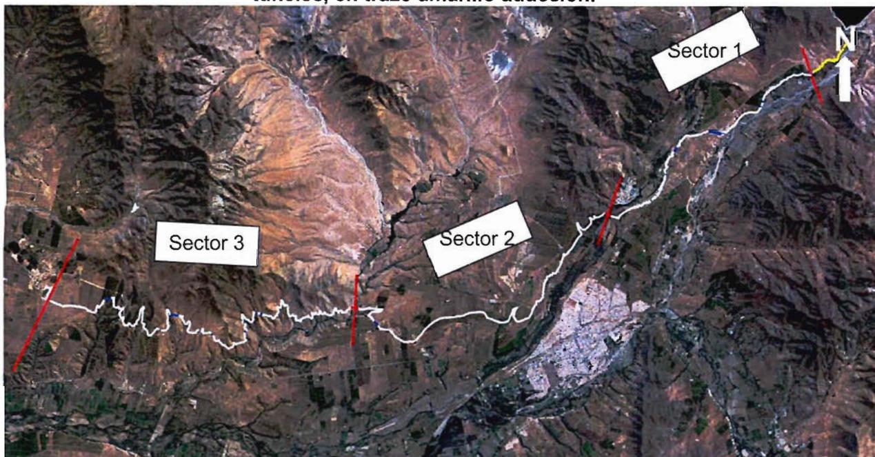
El canal Villalón, con una longitud aproximada de 51 Km de los cuales aproximadamente 1,70 km corresponde a 26 tramos en túnel, se excavó principalmente en depósitos de suelos aluviales, aluviales y coluviales y aluviales pertenecientes principalmente a la Formación Confluencia del Mioceno Plioceno y, en menor proporción, en rocas volcánicas e intrusivas del Jurásico a Cretácico.
