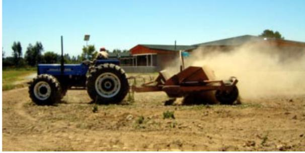
**Foto 10.** Labor de nivelación de un terreno con una “trailla”, equipo que permite una máxima efectividad en la labor.
