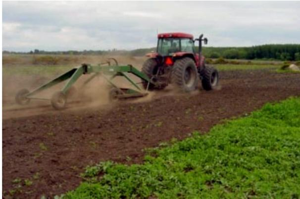
**Foto 11.** Movimiento superficial de suelo con una microneveladora, emparejándolo para el riego.
