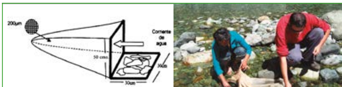
Figura 28. (Izquierda): Esquema dimensional de la red Surber. La flecha indica dirección del flujo, la cual transita por este portal llegando a una malla de diámetro de por de 200 micrómetros ( \mu m), (1 milímetro son 1000 micrómetros) (Merrit y Cummins, 1984). (Derecha): Aplicación de la red Surber en terreno.
