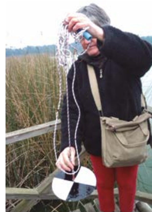
Figura 21: Disco Secchi, utilizado por la Profesora Matilde López, en taller sobre monitoreo de humedales, Reserva Nacional Laguna Torca, Región del Maule, mayo 2015.
