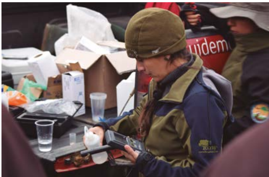
Figura 20. Personal de CONAF en proceso de calibrar equipo que mide la conductividad eléctrica, entre otras variables, en taller de capacitación sobre monitoreo de humedales, realizado en la Reserva Nacional Laguna Torca, Región del Maule, mayo 2015
