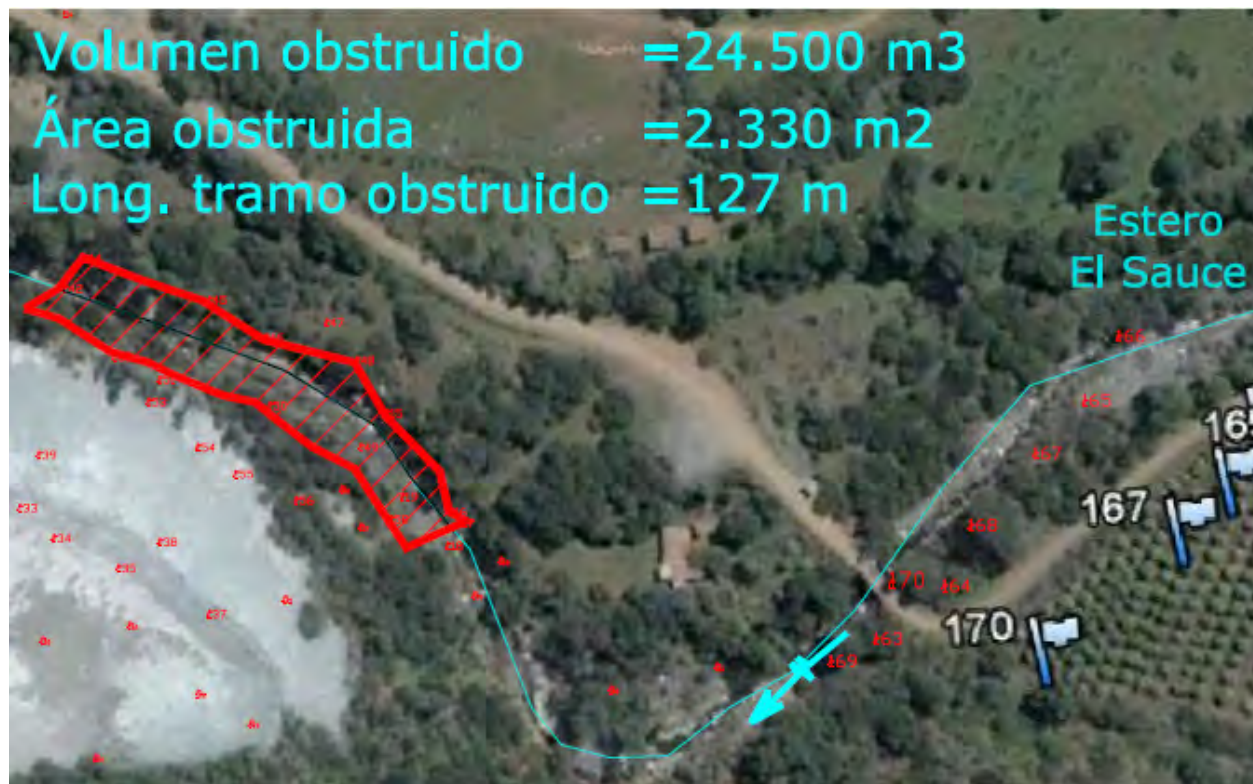
Figura 3. Dimensionamiento de la obstrucción del Estero El Sauce.
