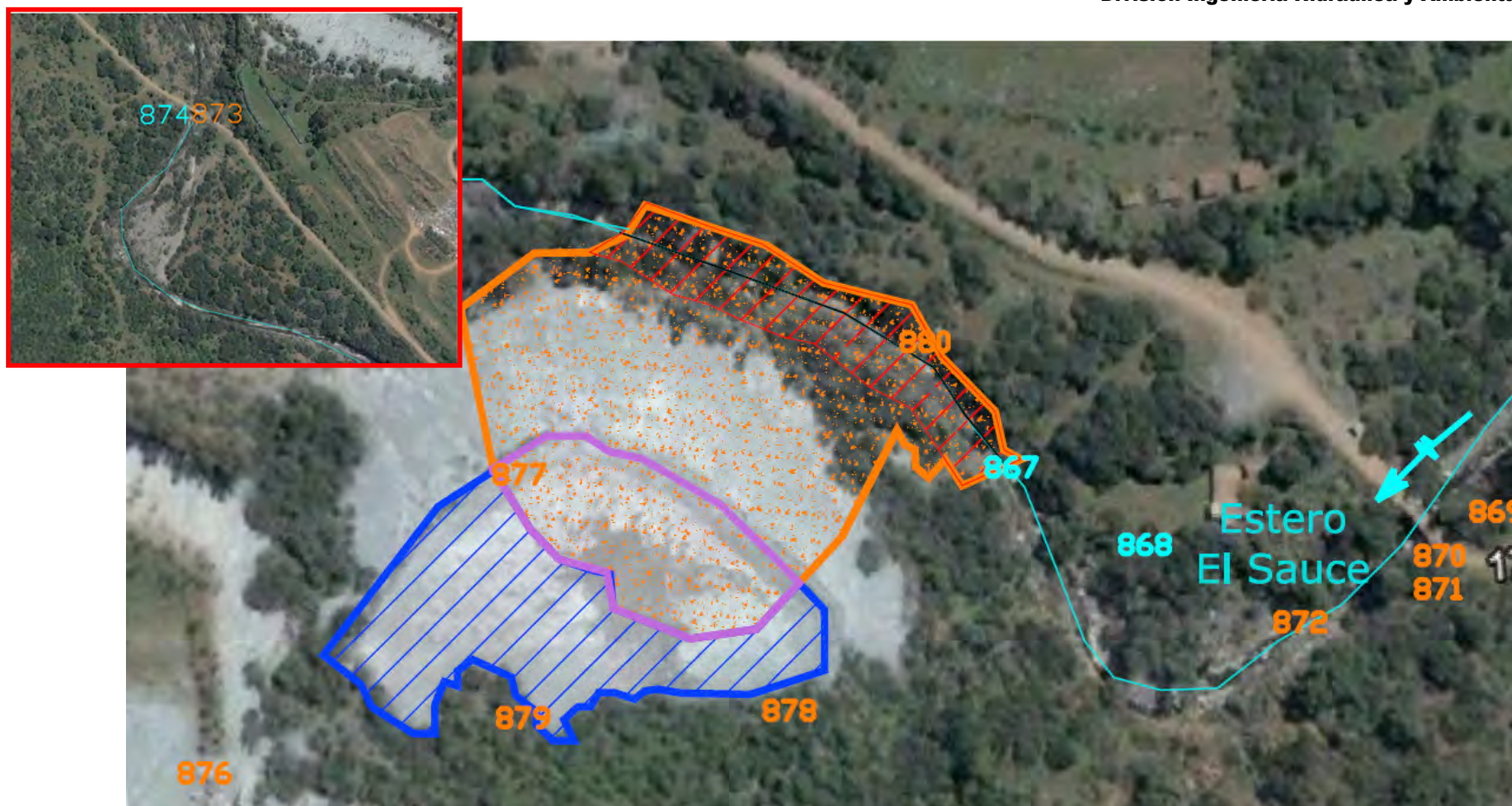
Figura 9. Plano de localización de puntos georeferenciados de muestreo. En naranja se observan las muestras sólidas y en celeste las líquidas. Los puntos de muestreo 874 y 873 fueron tomados 1.9 km aguas abajo de la zona afectada y los puntos 869, 870, 871, 872 aproximadamente 250 metros aguas arriba.
