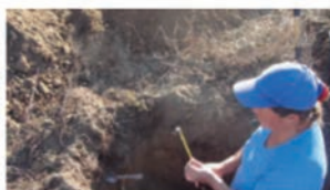
Calicata para revisar el perfil de suelo y profundidad
