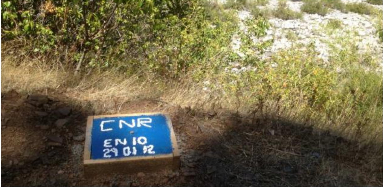
Figura 3-2: Monumentación Topografica - Zona de Embalses
