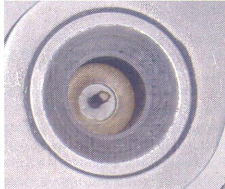
Pecíolo de una hoja en la tapa de una Bomba de Scholander. Cuando la presión en la cámara es equivalente a la tensión de la savia, la savia aparece por el pecíolo.
